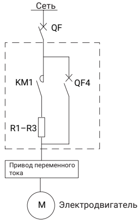
Рис. 1-17. Принципиальная схема шкафа предварительной зарядки на первичной стороне
